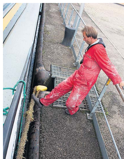
Fussarbeit: Bernard schaut, dass sich in der Schleuse der am Schwimmpoller befestigte Festmacher nicht an der Mauer verhakt, wenn sich das Schiff absenkt.
